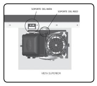
**Paso 3:** Accione el motor y observe si los REED's están apagando correctamente. Si es necesario, invierte el conector de la placa.
