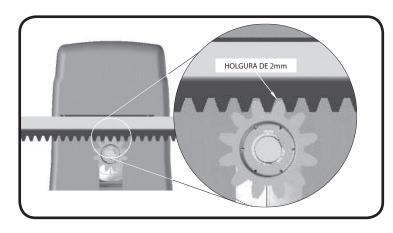
**Paso 7:** 7º Paso: Fije la cremallera en toda la extensión de la hoja del portón con soldadura o tornillo cada 300 o 400 mm.
