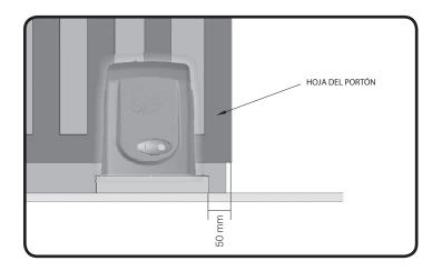
**Paso 4:** Haga la pre-alineación del automatizador al portón, poniendo la cremallera sobre el engranaje y apoyando el conjunto al portón. A continuación, marque los agujeros de fijación en el piso o base de cemento.
