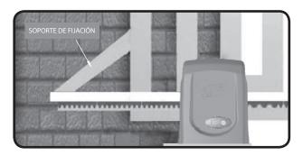
**Paso 9:** Después de la fijación de la cremallera, fije definitivamente el automatizador en el piso o base de cemento, apretando definitivamente los tornillos.
