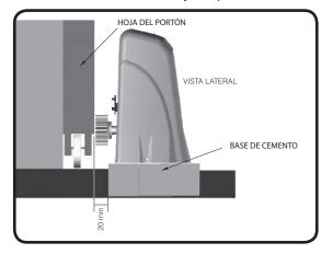
**Paso 3:** Atendidas las condiciones, abra totalmente la puerta y coloque el automatizador cerca de la cara de la hoja del portón, obedeciendo la medida de 50 mm entre el extremo de la hoja y el automatizador.
