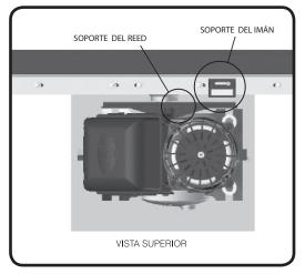
**Paso 2:** Abra completamente el portón y ponga el otro soporte del imán en la cremallera, de frente con el REED del automatizador. Este imán actuará como fin de carrera de apertura.
