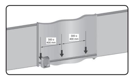
**Paso 8:** Si hay alabeo en la hoja del portón, ponga ampuesas para garantizar la alineación de la cremallera. Hay casos en que la cremallera debe pasar de la longitud de la hoja. En ese caso, proporcione un soporte de fijación para que no salten los dientes en el arranque de la máquina.
