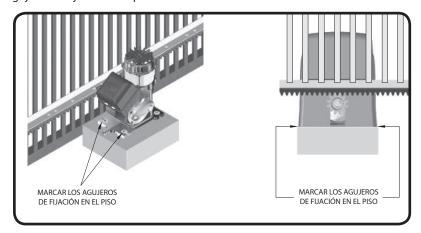
**Paso 5:** Haga la perforación para la fijación, poniendo el automatizador alineado al portón. Antes de apretar los tornillos 5 ¼ "x 2 ½", mueva el portón, verificando si el mismo no se apoya en el automatizador en el transcurso de su recorrido. En caso de que esto ocurra, mueva el automatizador.
