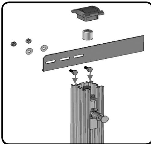
**Paso 3:** Introduzca el stop de cierre con el caucho orientado hacia la tuerca accionadora.
