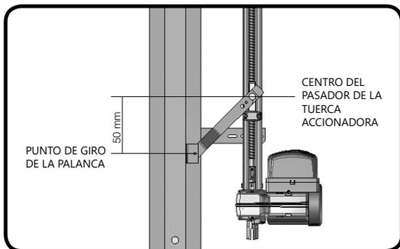
**Paso 10:** Con el portón aún cerrado, ajuste el stop de cierre, de modo que su caucho amortice la tuerca accionadora cuando cierre el portón. Después, con el portón abierto, realice el procedimiento para el stop de apertura.
